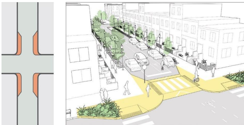
Paaugstinātas gājēju pāreja ar brauktuves sašaurinājumu kā atgādinājums par ātruma samazinājumu mazākas nozīmes ielā.
