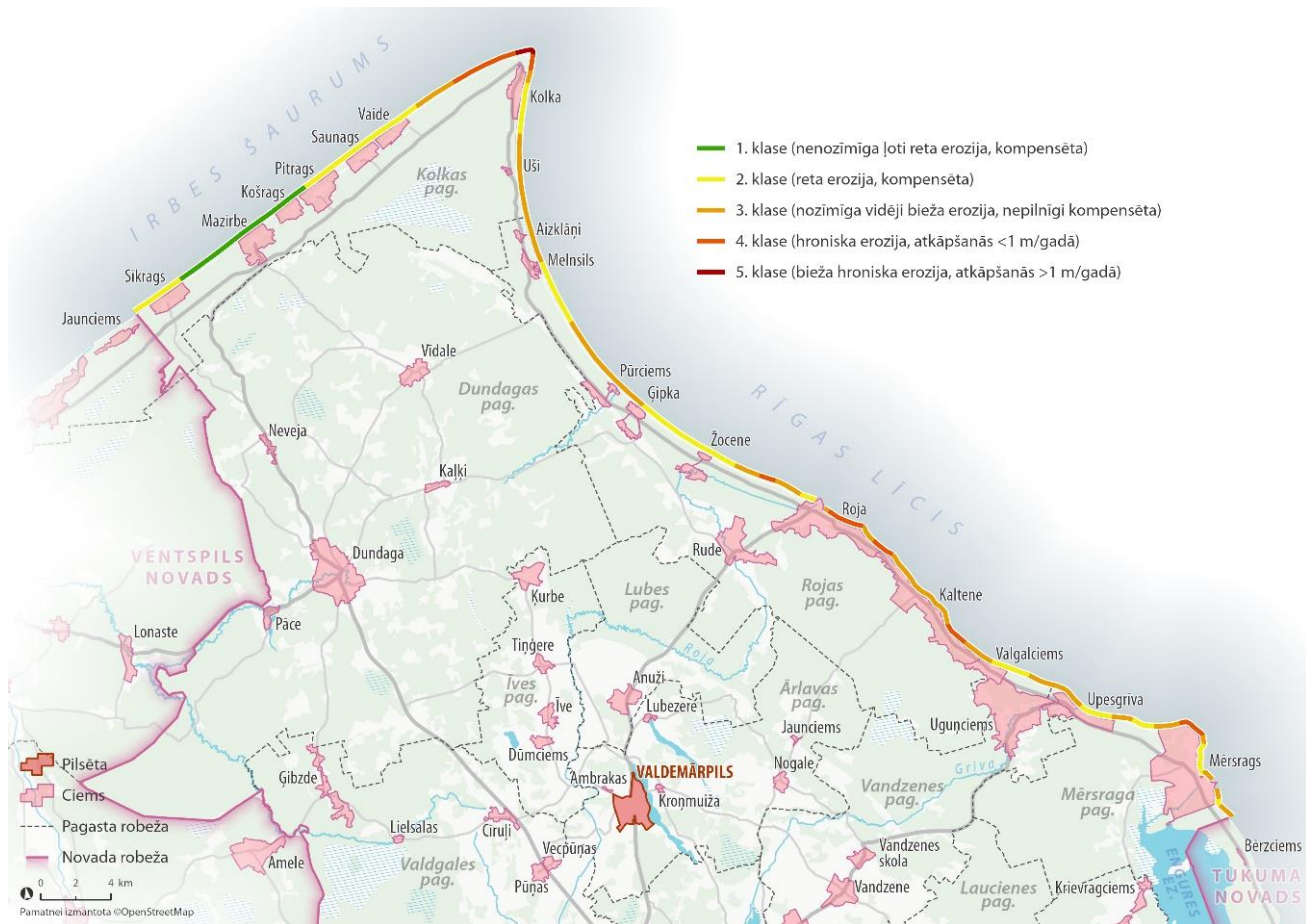
2. attēls Erozijas procesu intensitātes vērtējums ilgtermiņā (avots: metodiskais materiāls „Vadlīnijas jūras krasta erozijas seku mazināšanai”)
